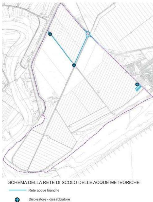
Figura 3-15: Schema della rete di scolo delle acque meteoriche
